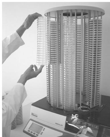
MEDIAJET fordert Sie auf, die gefüllten Schalen aus den zwei Ladepositionen zu entfernen.
