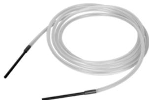
Silikonschlauchsatz, bestehend aus einem Silikonschlauch 3,0 mm ID, 2,5 m Länge, Ansaugtülle und Dispensierstück aus Edelstahl, jeweils 10 cm lang.
