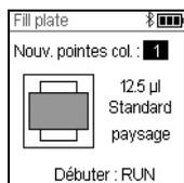
Appuyez sur **OK** pour sélectionner la première rangée / colonne complète de pointes, par exemple Colonne 2.
