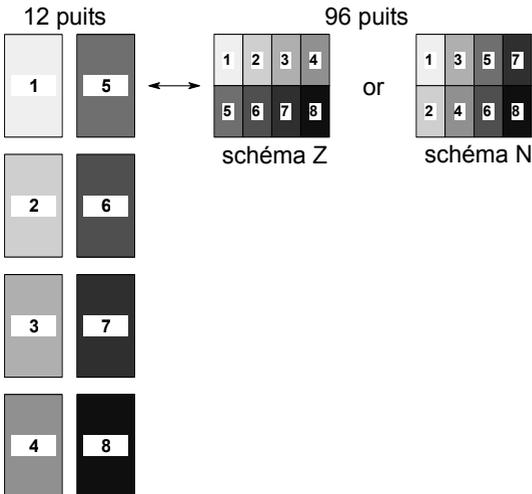
Reformatez huit plaques sources 12 puits avec une pipette VOYAGER 4 canaux (300 µl) en huit rectangles d'une plaque cible 96 puits.
