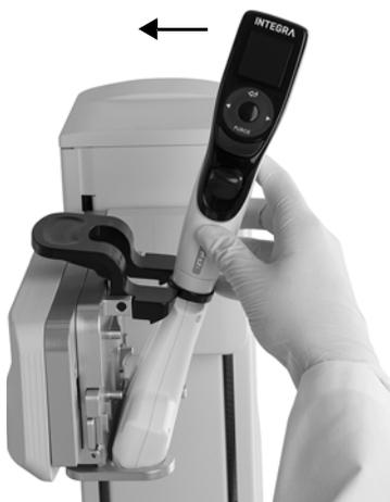
Pour mettre en place une pipette, l'ouverture de l'éjecteur de pointes (33) doit faire face au **Support de pipette** (4).
