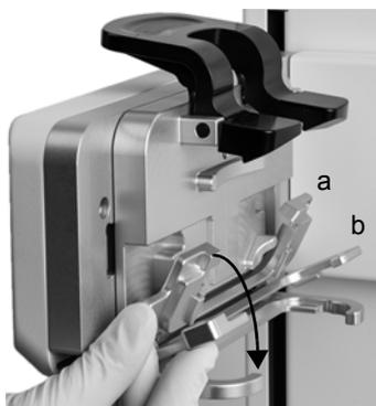
Pour adapter le porte-pipette à une pipette VIAFLO à 8 ou 16 canaux, abaissez les deux leviers argentés (a, b) comme illustré ci-contre.
