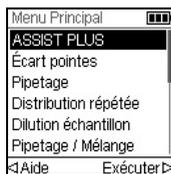
Sélectionnez le mode ASSIST PLUS dans le Menu Principal de la pipette INTEGRA, puis appuyez sur **OK**. La pipette établit la connexion Bluetooth.
