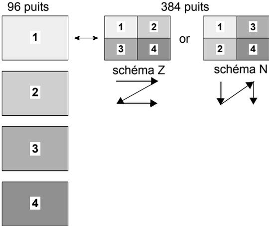
Reformatez quatre plaques sources 96 puits avec une pipette VOYAGER 8 canaux en quatre rectangles d'une plaque cible 384 puits.
