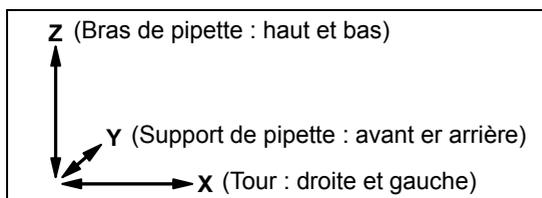
15 Les touches fléchées ▲ **Up** (haut) et ▼ **Down** (bas) déplacent la pipette le long de l'axe Z pour définir les hauteurs de pipetage.
