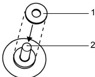
▶ Setzen Sie die Scheibe (1) auf den Drehzapfen (2) in der Küvette und drücken Sie sie ganz nach unten auf den Boden.
