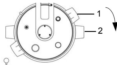
▶ Schließen Sie den Kesseldeckel, indem Sie ihn an den Handgriffen im Uhrzeigersinn um den Anschlagpunkt drehen. Die Handgriffe(1) müssen über den schwarzen Aufklebern (2) zu liegen kommen.
