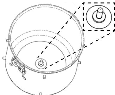
Die weisse Drehzapfenscheibe (aus PTFE-Material) befindet sich am Boden der Küvette.
