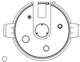
▶ Wenn der Kesseldeckel nicht so positioniert ist, wie auf dem nebenstehenden Bild gezeigt, ist die Sicherheit des Gerätes nicht gewährleistet.
