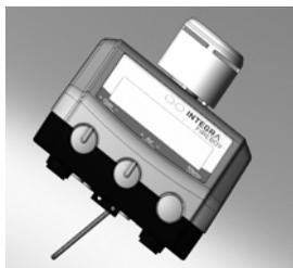
Pour éviter tout encrassement du tube du brûleur lors de la manipulation de liquides, le FIREBOY plus peut être incliné à l'aide de l'étrier support escamotable qui se trouve sur la face inférieure.
