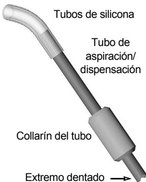
Los tubos de dispensación y aspiración que se proporcionan con la DOSE IT facilitan el proceso de dispensación y se colocan en los extremos de los tubos. El tubo de aspiración es dentado en un extremo para garantizar que el líquido que entra por los tubos fluya libremente. Asegúrese de no insertar el extremo dentado del tubo de aspiración en los tubos de silicona.
