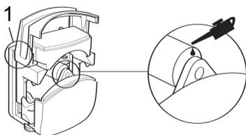
Las piezas móviles del cabezal se deben comprobar de vez en cuando para verificar la libertad de movimiento.
