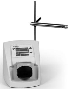
Fije la barra de soporte con los dos tornillos de la parte trasera con un destornillador Phillips (PH2), véase “Tuercas para fijar la barra de soporte” en la página 8.
