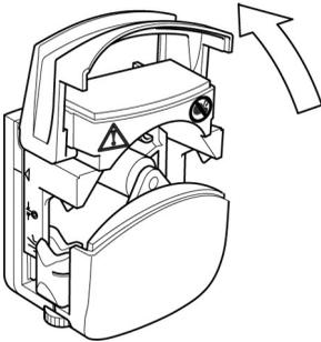
1 Abra el cabezal de la bomba
