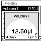
Markieren Sie das Sollvolumen mit dem **Kontrollrad** und drücken Sie  $\triangleright$  Auswählen. Alternativ können Sie ein Volumen ändern, indem Sie auf  $\triangleleft$  Bearbeiten drücken.
