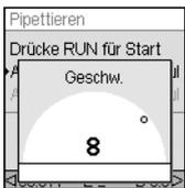
Markieren Sie in einem Pipettiermodus die Option „Geschw.“ mit dem **Kontrollrad** und drücken Sie **OK**. Wählen Sie die Geschwindigkeit aus und drücken Sie zum Speichern Ihrer Einstellung **OK**.
