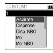
Após primeira fase ser realçada, prima **OK**. Um programa Custom (Personalizado) deve começar com uma das seguintes fases: Aspirate (Aspirar), Mix (Misturar), Prompt (Mensagem) ou Tip spacing (Espaçamento de pontas). Utilize a **Roda tátil** para seleccionar a primeira fase (por ex., Aspirate [Aspirar]) e prima **OK**.
