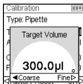
Realce o Target Volume (Volume-alvo) ( $V_T$ ) no menu Calibration (Calibração). Prima **OK**.
