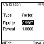
Prima  $\triangleright$  para aplicar o fator de correção. Isto ajustará a pipeta para aplicar o volume exato. O utilizador será redirecionado para o menu Calibration (Calibração).
