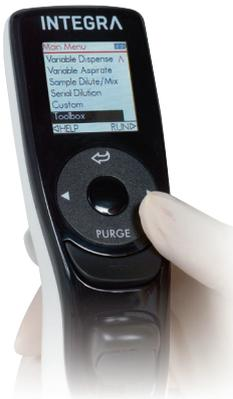
Die elektronischen VIAFLO-Pipetten sind einfacher zu handhaben als manuelle Pipetten. 10 vordefinierte Pipettierprogramme, bei denen nur wenige Parameter wie Volumen und Geschwindigkeit vom Anwender definiert werden müssen, ermöglichen einen sofortigen und unkomplizierten Start.
