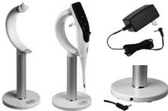
Setzen Sie die Pipette in den Ladeständer, indem Sie die Ladebuchse (15 oben auf der Rückseite der Pipette) mit dem Anschluss oben am Ständer verbinden.
