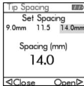
Verwenden Sie zum Ändern der Spitzenspreizung das Kontrollrad und blättern Sie zur Position, die Sie ändern möchten. Drücken Sie auf **OK** und das Menü „Tip Spacing“ (Spitzenspreizung) wird angezeigt.
