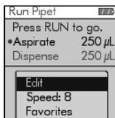
Führen Sie die Spitzen in die Flüssigkeit ein, die übertragen werden soll. Drücken Sie kurz auf die **Betriebstaste „Run“** (7), um das im ersten Schritt Ihres Protokolls ausgewählte Volumen zu aspirieren (dies wird am Bildschirm „Run“ (Ausführen) angezeigt).
