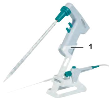
Der Ständer für PIPETBOY und VACUBOY ist ein ideales Zubehör für die Arbeit in einer Sicherheitswerkbank. Dadurch bleibt der Arbeitsplatz aufgeräumt und PIPETBOY acu 2 ist mit oder ohne eingesetzte Pipette immer verfügbar.
