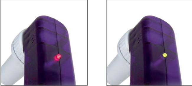
Eine leuchtende LED zeigt durch Wechsel von grün auf rot an, dass der Akku geladen werden muss.
