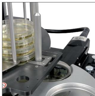
Le module pour imprimante à jet d'encre IMAJE 9020 permet d'imprimer sur la paroi latérale des boîtes de Pétri. Le choix de cette technique est intéressant car l'impression ne compromet pas l'utilisation d'un lecteur de plaques ou compteur de colonies. Les boîtes de Pétri peuvent aussi être imprimées sur leur fond avec une imprimante à jet d'encre LINX (LINX 8900, par exemple).
