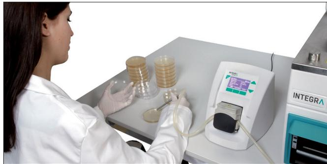
Zusätzlich kann die Peristaltikpumpe DOSE IT zum Befüllen von Gefäßen mit unüblichen Formen und Volumen benutzt werden, z. B. rechteckige Petrischalen oder Flaschen.
