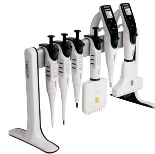
Der Benutzer kann bis zu vier Lade-/Kommunikationsstationen hinzufügen und den Ständer so in eine Ladeoption für elektronische Pipetten von INTEGRA verwandeln. Zusätzlich wird ein Netzteil benötigt.
