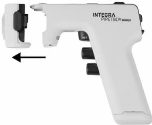
Um das Nasenstück (9) zu zerlegen, drücken Sie den schwarzen Schnappverschluss (10) auf beiden Seiten und nehmen das äußere Nasenstückteil seitlich ab.
