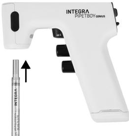
Stecken Sie die Pipette in das Nasenstück ein, bis Sie einen leichten Widerstand spüren. Die Steady-Grip-Funktion ermöglicht das Einrasten der Pipetten aller Volumen in eine stabile und sichere Position.
