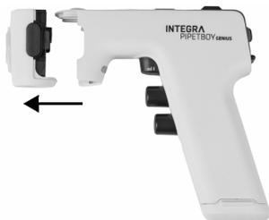
Pour démonter le nez (9), appuyez sur la pièce d'ajustement par encliquetage noire (10) des deux côtés et retirez la partie extérieure du nez depuis le côté.
