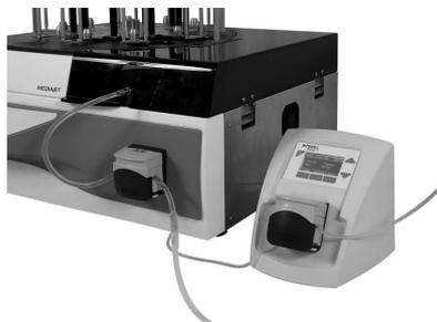
Wenn der sterilisierte Schlauchsatz für die Herstellung des Blutagars angeschlossen werden soll, muss der Schlauch mit dem kleineren Innendurchmesser (2 x 5mm) in den Pumpkopf der DOSE IT eingelegt werden und der mit dem größeren (6 x 9 mm) in den Pumpkopf des MEDIAJETs. Das Glas-T-Stück muss vor dem Pumpkopf des MEDIAJETs liegen.
