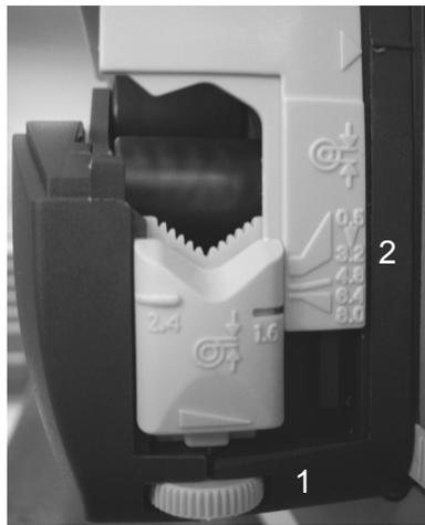
Die Einstellung der Schrauben (1) auf beiden Seiten des Pumpkopfes ist vom benutzten Schlauchtyp abhängig:
