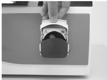
▶ Öffnen Sie den Deckel des Pumpenkopfes.
