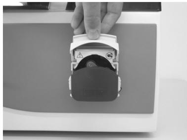
► Öffnen Sie den Deckel des Pumpenkopfes.
