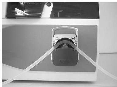
► Legen Sie den Schlauchsatz in die Pumpe ein, so dass die Fülldüse auf der linken Seite des Pumpenkopfs liegt.
