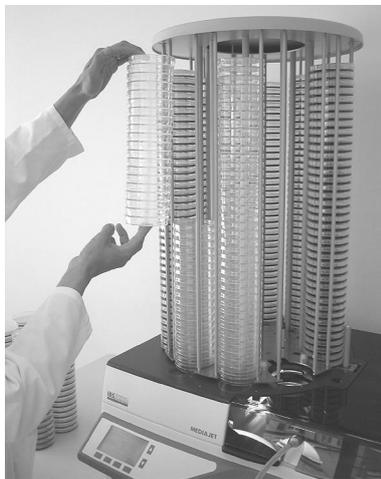
MEDIAJET fordert Sie auf, die gefüllten Schalen aus den zwei Ladepositionen zu entfernen.
