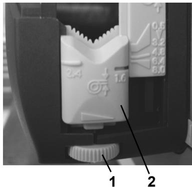
► Drehen Sie auf beiden Seiten des Pumpenkopfes die Justierschrauben **1** so weit nach rechts (Gegenuhrzeigersinn) wie möglich.
