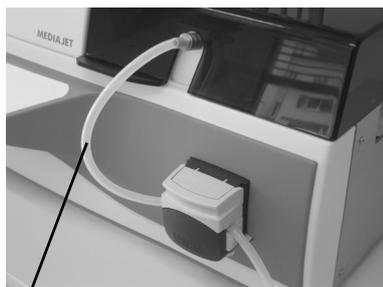
Sie benötigen ca. 30 cm Schlauch **3** zwischen der Pumpe und dem Fülldüsenhalter.
