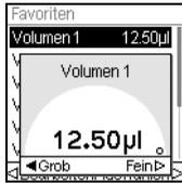
Markieren Sie das Sollvolumen mit dem **Kontrollrad** und drücken Sie **▷ Auswählen**. Alternativ können Sie ein Volumen ändern, indem Sie auf **◀ Bearbeiten** drücken.
