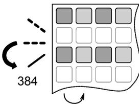
Die vordere Position des **Plattenschiebers** wird benutzt, um die hinteren Positionen der 384-Well-Platten anzusteuern.
