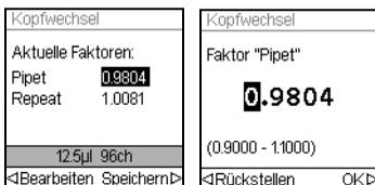
Wählen Sie den Faktor „Pipet“ und klicken Sie dann auf < Bearbeiten, um den Pipettierfaktor entsprechend zu ändern. Wählen Sie mit dem **Kontrollrad** die Stelle, die geändert werden soll, drücken Sie dann **OK** und wählen Sie mit dem **Kontrollrad** eine Ziffer. Drücken Sie zur Bestätigung **OK**. < Rückstellen setzt den Faktor auf 1.0000.
