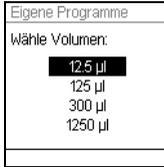
Klicken Sie auf  $\triangleright$ , um ein neues Programm zu erstellen. Wählen Sie das Volumen des Pipettierkopfs und den Typ des neuen benutzerdefinierten Programms aus, d. h. „Manuell“ oder „Automatisch“.
