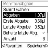
Es wird eine Liste der zugeordneten Schritte eingeblendet. Beispiel: Wenn Sie die Option Bearbeiten am Bildschirm Mehrfachabgabe auswählen, werden die der Mehrfachabgabe zugeordneten, änderbaren Schritte angezeigt.
