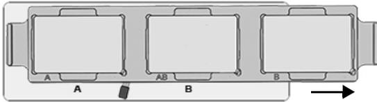
Bewegen Sie die 3-Positionenplattform nach rechts, um an den Positionen A und AB zu pipettieren.
