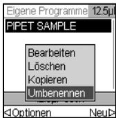
Markieren Sie in der Anzeige „Eigene Programme“ ein vorhandenes Programm. Drücken Sie  $\triangleleft$  Optionen, wählen Sie mit dem **Kontrollrad** eine Option (Bearbeiten, Löschen, Kopieren, Umbenennen), um das Programm zu modifizieren und drücken Sie **OK**.
