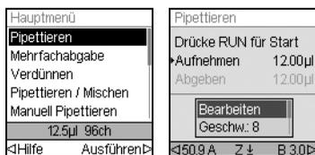
Tauchen Sie die Spitzen in die Flüssigkeit, die übertragen werden soll. Drücken Sie kurz auf die **Betriebstaste „RUN“** (17), um das im ersten Schritt Ihres Protokolls ausgewählte Volumen zu aspirieren (dies wird am Bildschirm angezeigt).
