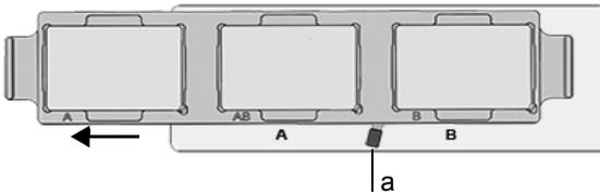
Bewegen Sie die 3-Positionenplattform nach links, um an den Positionen AB und B zu pipettieren.
