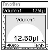
Markieren Sie das Sollvolumen mit dem **Kontrollrad** und drücken Sie ▶ Auswählen. Alternativ können Sie ein Volumen ändern, indem Sie auf ◀ Bearbeiten drücken.
