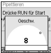
Markieren Sie in einem Pipettiermodus die Option „Geschw.“ mit dem **Kontrollrad** und drücken Sie **OK**. Wählen Sie die Geschwindigkeit aus und drücken Sie zum Speichern Ihrer Einstellung **OK**.
