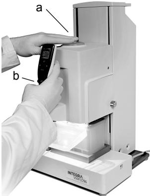
Wenn Sie dazu aufgefordert werden, drücken Sie den **Spitzenladeknopf** und drücken Sie gleichzeitig die **Steuereinheit** nach unten. Wenn die Spitzen geladen sind, leuchtet der **Spitzenladeknopf** auf.
