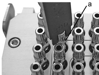
Placez l'outil de retrait des joints toriques verticalement entre les raccords de l'embout (ne pas incliner).
