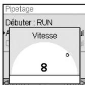
En mode de pipetage, utilisez la **molette tactile** pour surligner l'option Vitesse et appuyez sur **OK**. Sélectionnez la vitesse et appuyez sur **OK** pour sauvegarder votre configuration.
