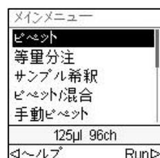
メインメニューから、**タッチホイール**を使用して、目的の機能ベースのプログラムまでスクロールします。**OK** を押してプログラムに入り、分注量やスピードなどの設定を開始します。
