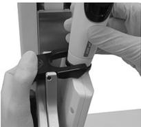
Um die elektronische VIAFLO-Pipetten herauszunehmen, drücken Sie die linke Seite des schwarzen Greifers herunter, damit er die Pipette freigibt.
