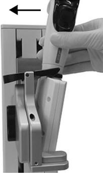
Um die Pipette zu installieren, setzen Sie sie schräg in den Pipettenhalter ein.
