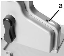
Für Feineinstellungen der Pipette entlang der Y-Achse drehen Sie die Schraube am Pipettenhalter (a) mit einem Schlitzschraubendreher der Größe 2. Drehen im Uhrzeigersinn bewegt die Pipette nach hinten, gegen den Uhrzeigersinn nach vorne. Die maximale Y-Verschiebung beträgt +/- 5 mm.
