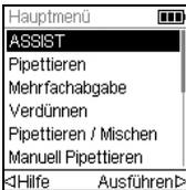
Wählen Sie ASSIST vom Hauptmenü der VIAFLO-Pipetten und drücken Sie **OK**. Die Pipette baut die Verbindung über das ComModul auf.
