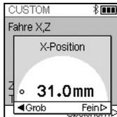
Sind die exakten Werte der Höhen bzw. X-/Z-Position bekannt, können sie mit dem **Kontrollrad** direkt eingegeben werden.
