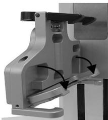
Um den Halter für eine 8- oder 16-Kanalpipette anzupassen, ziehen Sie den silbernen Hebel herunter, wie im Bild nebenan gezeigt.
