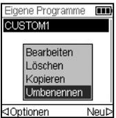
Markieren Sie mit dem **Kontrollrad** in der Anzeige „Eigene Programme“ ein vorhandenes Programm und drücken Sie < Optionen. Wählen Sie eine Option (Bearbeiten, Löschen, Kopieren, Umbenennen), um das Programm zu modifizieren, und drücken Sie **OK**.
