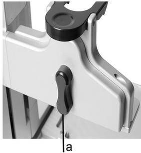
Placez le levier (a) au centre pour pipeter dans des plaques 96 puits.
