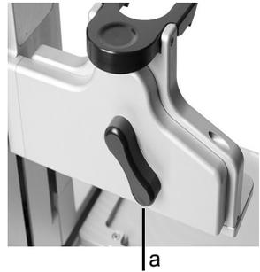
La position avant du levier (a) déplace la pipette vers l'avant pour qu'elle puisse atteindre les positions avant des plaques 384 puits.
