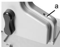
Pour un réglage précis des embouts de la pipette le long de l'axe Y, faites tourner la vis présente sur le porte-pipette (a) à l'aide d'un tournevis à tête plate taille 2. Faites-la tourner dans le sens horaire pour reculer la pipette et dans le sens anti-horaire pour l'avancer. Le décalage Y maximal est de +/- 5 mm.
