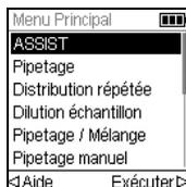
Sélectionnez le mode ASSIST dans le Menu Principal de la pipette VIAFLO, puis appuyez sur **OK**. La pipette établit la connexion via le module de communication.
