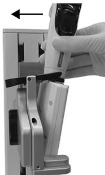
Pour mettre en place une pipette, inclinez-la puis insérez-la dans le porte-pipette.
