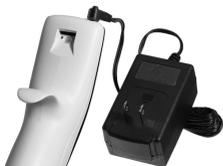
Insérez le connecteur de l'adaptateur secteur dans la prise femelle située en haut, à l'arrière de la pipette. Branchez ensuite l'adaptateur à une prise murale.
