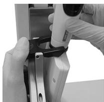
Pour dégager la pipette électronique VIAFLO, relevez la pince noire en appuyant sur une extrémité.
