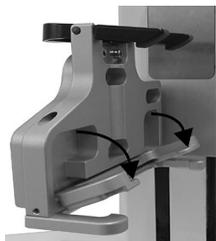
Pour adapter le porte-pipette à une pipette à 8 ou 16 canaux, abaissez le levier argenté comme illustré ci-contre.
