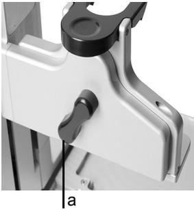
La position arrière du levier (a) déplace la pipette vers l'arrière pour qu'elle puisse atteindre les positions arrière des plaques 384 puits.
