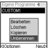
Markieren Sie mit dem **Kontrollrad** in irgendeiner Programmkategorie ein vorhandenes Programm und drücken Sie  $\triangleleft$  Optionen. Wählen Sie eine Option (Bearbeiten, Löschen, Kopieren, Umbenennen), um das Programm zu modifizieren, und drücken Sie **OK**.
