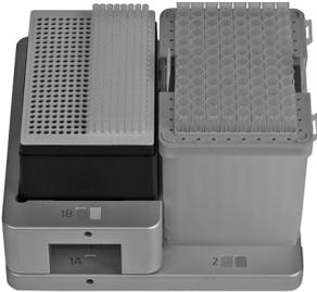
Setzen Sie den zweiten Aufsatz ein, um den 12,5- oder 125-µl-Tip-Behälter anzuheben, so dass beide Behälter bei Verwendung von 300-µl-LONG- oder 1250-µl-GripTips die gleiche Höhe haben.
