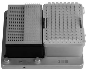
Linke Seite: rosa 12,5-µl- oder gelber 125-µl-Behälter. Die 192 Spitzen auf der rechten Hälfte des Behälters können geladen werden. Drehen Sie anschließend den Behälter um 180°, um die Spitzen der linken Hälfte zu verwenden.
