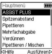
Wählen Sie ASSIST PLUS vom Hauptmenü der elektronischen Pipette und drücken Sie **OK**. Die Pipette baut die Bluetooth-Verbindung auf.
