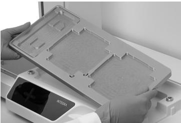
Halten Sie das **Deck** (7) mit beiden Händen und setzen Sie es in die entsprechenden Positionierbolzen. Drücken Sie es fest herunter bis sie es hörbar einrastet.
