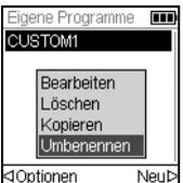
Markieren Sie mit dem **Kontrollrad** in irgendeiner Programmkategorie ein vorhandenes Programm und drücken Sie < **O**ptionen. Wählen Sie eine Option (Bearbeiten, Löschen, Kopieren, Umbenennen), um das Programm zu modifizieren, und drücken Sie **OK**.
