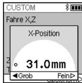
Sind die exakten Werte der Höhen bzw. X-/Y-/Z-Position bekannt, können sie mit dem **Kontrollrad** direkt eingegeben werden.
