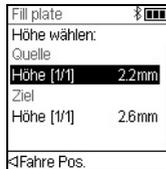
Drücken Sie ◀ **Fahre Pos.** und drücken Sie die **Start/ Pause-Taste** am ASSIST PLUS, um die Pipette in die programmierte Position zu bewegen.
