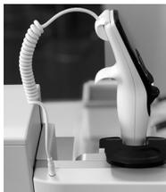
Klicken Sie den 4-poligen Stecker des Kommunikationskabels in die Rückseite der Pipette ein und stecken Sie das Kabel in den Pipettenhalter des ASSIST PLUS.
