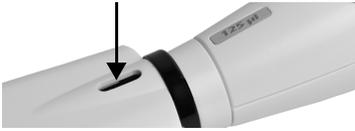
Damit die Spitzen automatisch abgeworfen werden können, entfernen Sie mit Ihrem Daumen den **Spitzenabwerferdeckel** (34) und bewahren Sie ihn an einem sicheren Ort auf (nur Pipetten mit einer Seriennummer  $\geq 7\ 000\ 000$ ).
