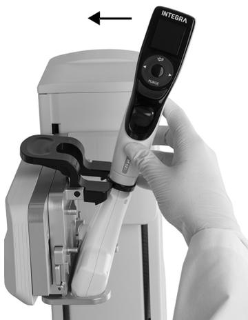
Pour mettre en place une pipette, l'ouverture de l'éjecteur de pointes (34) doit faire face au **support de pipette (4)**.
