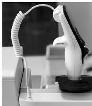
Insérez le connecteur 4 broches du câble de communication à l'arrière de la pipette et branchez le câble au support de pipette de l'ASSIST PLUS.
