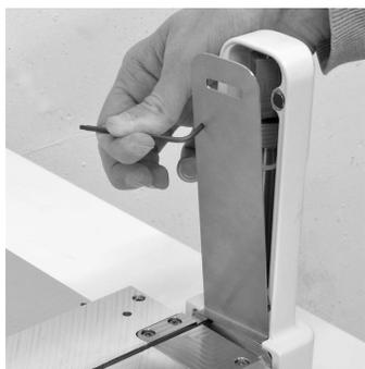
Nettoyage du laser du capteur de détection de pointe
