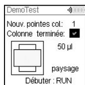
Appuyez sur **OK** pour sélectionner la première rangée / colonne de pointes, par exemple Colonne 2.
