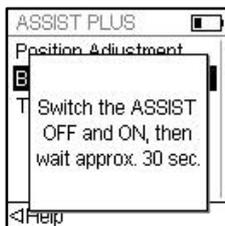
第一次将特定的移液器连接到 ASSIST PLUS 时，需要将两种仪器配对。
