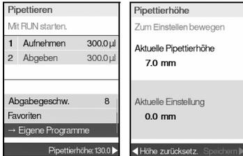
Bringen Sie die **Pipettiereinheit** mit aufgesteckten Spitzen auf die gewünschte Pipettierhöhe.
