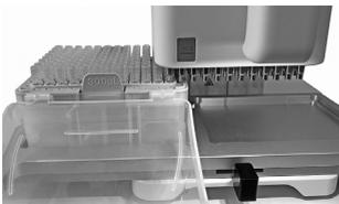
Platzieren Sie einen Behälter entweder links oder rechts und schieben Sie die 2-Positionen-Plattform unter die Pipettiereinheit entsprechend der Anzahl der zu ladenden Reihen.
