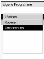
Markieren Sie in der Anzeige „Eigene Programme“ ein vorhandenes Programm mit dem **Kontrollrad**. Drücken Sie ◀ Optionen, wählen Sie mit dem **Kontrollrad** eine Option (Löschen, Kopieren, Umbenennen), um das Programm zu modifizieren und drücken Sie **OK**.
