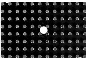
Support magnétique pour plaques PCR à 384 puits
