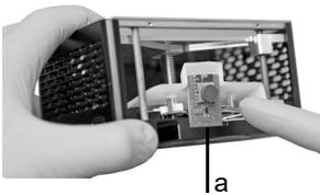
Utilisez un tournevis Torx pour dévisser les 4 vis à l'arrière du module et retirez le capot.
