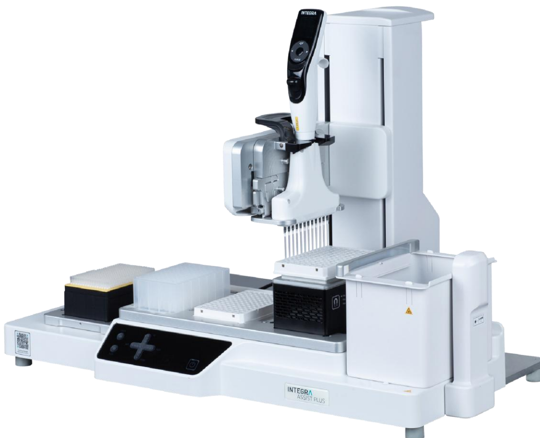
Abbildung 3: ASSIST PLUS-Pipettierplattform mit integriertem MAG-Modul und der VOYAGER-Pipette von INTEGRA.
