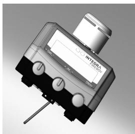
Para evitar que se ensucie el tubo de combustión cuando se trabaja con líquidos, se puede inclinar FIREBOY plus con la ayuda de la plataforma plegable que se encuentra en la parte inferior del dispositivo.
