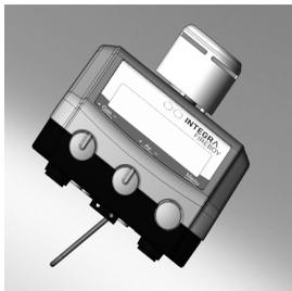
Per evitare che con l'impiego di liquidi il tubo del bunsen si sporchi, il FIREBOY plus può essere inclinato appoggiandolo sull'apposita staffa di appoggio apribile che si trova sotto la base.
