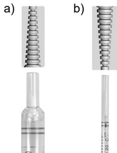
El soporte de la pipeta (11c) presenta un canal cónico especial para garantizar un agarre firme y sin fugas de la pipeta con independencia de su diámetro.
