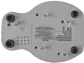
Afije los 5 tornillos en la parte inferior del dispositivo con un destornillador Phillips Nr. 1 y retire la tapa inferior.
