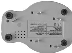
Lösen Sie die 5 Schrauben am Boden des Geräts mit einem Kreuzschlitzschraubendreher Nr. 1 und nehmen Sie den Bodendeckel ab.
