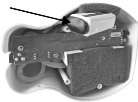
Desconecte la batería vieja y reemplácela con una batería recargable original de INTEGRA Biosciences - ver «7 Accesorios» en la página 15. Asegúrese de haberla introducido con la polaridad correcta (+/-).
