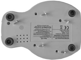
Afloje los 5 tornillos en la parte inferior del dispositivo con un destornillador Phillips Nr. 1 y retire la tapa inferior.
