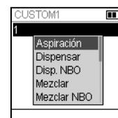
El primer paso se resalta y debe pulsar **OK**. Un programa personalizado debe empezar con las tareas Aspiración, Mezclar, Pronto o Mover punta. Utilice la **rueda táctil** para seleccionar el primer paso, p. ej. Aspiración, y pulse **OK**.
