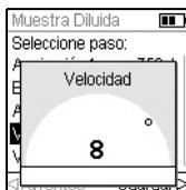
La velocidad puede cambiarse en la mayoría de menús de edición. Navegue hasta **Velocidad** y pulse **OK**. Escoja la velocidad, pulse **OK** y pulse **▷** para guardar su selección.
