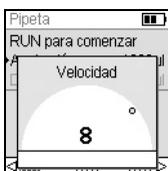
En cualquier modo de pipeteo, utilice la **rueda táctil** para resaltar la opción **Velocidad** y pulse **OK**. Escoja la velocidad y pulse **OK** para guardar su selección.
