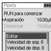
Inserte las puntas en el líquido que desea transferir. Presione y suelte **RUN** (Ejecutar) (7) para aspirar el volumen seleccionado en el primer paso de su protocolo (mostrado en la pantalla Run (Ejecutar)).
