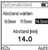
Verwenden Sie zum Ändern einer Spitzenspreizung das Kontrollrad und wählen Sie entweder die erste, mittlere oder letzte Position. Drücken Sie auf **OK** und das Menü „Abstand wählen“ wird angezeigt.
