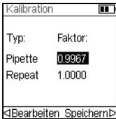
Drücken Sie  $\triangleright$ , um den Korrekturfaktor anzuwenden. Dies passt die Pipette an, so dass sie das richtige Volumen abgibt. Sie gelangen nun zum Menü „Kalibration“ zurück.
