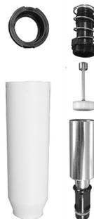
Die Komponenten können bei 121 °C, 1 bar Überdruck 20 min lang autoklaviert werden.
