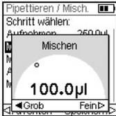
Verwenden Sie das **Kontrollrad**, um das Volumen zu markieren, das Sie ändern wollen (Aufnehmen, Abgeben, Mischen oder Luftspalt).
