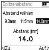
Verwenden Sie zum Ändern einer Spitzenspreizung das Kontrollrad und wählen Sie entweder die erste, mittlere oder letzte Position. Drücken Sie auf **OK** und das Menü „Abstand wählen“ wird angezeigt.
