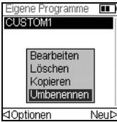
Markieren Sie mit dem **Kontrollrad** in der Anzeige „Eigene Programme“ ein vorhandenes Programm und drücken **◀** Optionen. Wählen Sie eine Option (Bearbeiten, Löschen, Kopieren, Umbenennen), um das Programm zu modifizieren.
