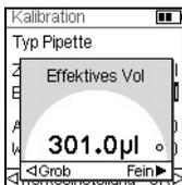
Setzen Sie den Cursor auf „Effektives Vol.“ (Istvolumen,  $\bar{V}$ ). Geben Sie das Istvolumen mit dem Kontrollrad ein. Verwenden Sie immer das hohe Testvolumen (100% des nominalen Volumens). Das Istvolumen ist der Mittelwert der durch den Z-Faktor korrigierten Gewichte. Das Ergebnis ist  $\bar{V}$ , das mittlere Volumen in Mikrolitern (siehe Abschnitt 7.5, 301  $\mu$ l in diesem Beispiel). Drücken Sie auf **OK**, um Ihre Auswahl zu speichern.
