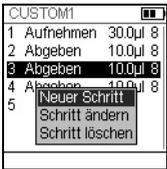
Um einen Schritt hinzuzufügen drücken Sie **◀** Bearbeiten, wählen Sie Neuer Schritt und drücken Sie **OK**.
