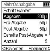
Es wird eine Liste der zugewiesenen Schritte eingeblendet. Beispiel: Wenn Sie die Option Bearbeiten am Bildschirm Mehrfachabgabe auswählen, werden die der Mehrfachabgabe zugewiesenen, änderbaren Schritte angezeigt.
