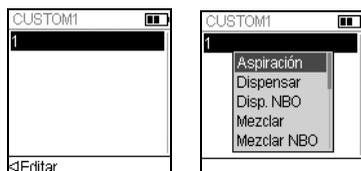
El primer paso se resalta y debe pulsar **OK**. Un programa personalizado debe empezar con las tareas Aspiración, Mezclar, Pronto o Mover punta. Utilice la **rueda táctil** para seleccionar el primer paso, p. ej. Aspiración, y pulse **OK**.
