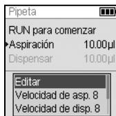
Inserte las puntas en el líquido que desea transferir. Presione y suelte la **tecla RUN** (Ejecutar) (7) para aspirar el volumen seleccionado en el primer paso de su protocolo (mostrado en la pantalla Run (Ejecutar)).
