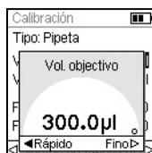
Resalte el Vol. objetivo ( $V_i$ ) en el menú Calibración. Pulse **OK**.
