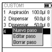
Para insertar un nuevo paso, pulse ◀ Editar, seleccione Nuevo paso y pulse **OK**.
