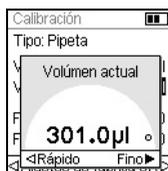
Mueva el cursor al Volumen real ( $\bar{V}$ ). Utilice la rueda táctil para introducir el Volumen real. Utilice siempre el volumen de prueba alto (100% del valor nominal). El volumen real es el promedio de los pesos corregidos por el factor Z, que da como resultado  $\bar{V}$ , el volumen medio en microlitros (consulte la sección 7.5, 301 µl en este ejemplo). Pulse **OK** para guardar su selección.
