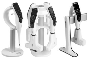
Coloque a pipeta no suporte de carregamento encaixando o recetáculo de alimentação (15, na parte superior traseira da pipeta) no conector de pinos que se encontra na parte superior do suporte.
