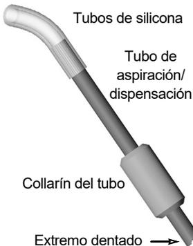
Los tubos de dispensación y aspiración que se proporcionan con la DOSE IT facilitan el proceso de dispensación y se colocan en los extremos de los tubos. El tubo de aspiración es dentado en un extremo para garantizar que el líquido que entra por los tubos fluya libremente. Asegúrese de no insertar el extremo dentado del tubo de aspiración en los tubos de silicona.
