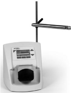
Fije la barra de soporte con los dos tornillos de la parte trasera con un destornillador Phillips (PH2), véase “Tuercas para fijar la barra de soporte” en la página 10.
