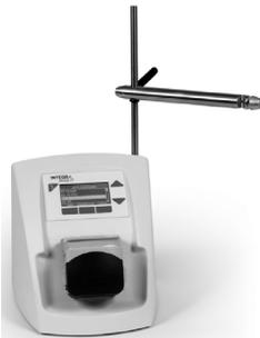
Fixieren Sie die Stativstange mit den zwei Schrauben unter Zuhilfenahme eines Kreuzschraubenziehers an der Geräterückseite, siehe „Schraubgewinde zur Fixierung der Stativstange“ auf Seite 10.
