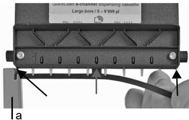
Führen Sie den Schlitz des mitgelieferten Streifen-Abziehwerkzeugs oder der Skalenleiste (Teil des Messmittels für Platten) und brechen Sie den Anti-Kollisionsstreifen vorsichtig an den drei Sollbruchstellen (siehe Pfeile) ab.
