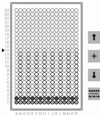
Wenn eine 384-Well-Platte mit einer 8-Kanal-Kassette oder eine 1536-Well-Platte mit einer 16-Kanal-Kassette befüllt werden soll, können Sie für jeden Quadranten ein anderes Füllvolumen definieren.
