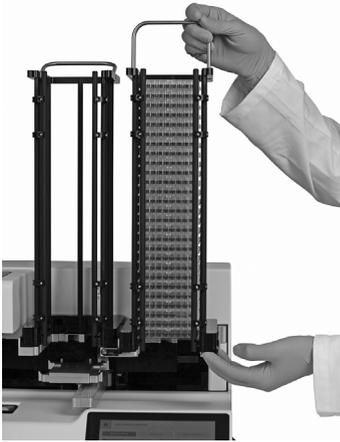
Halten Sie den Turm mit einer Hand am Griff und mit der anderen Hand am Rahmen am unteren Ende des Turms.
