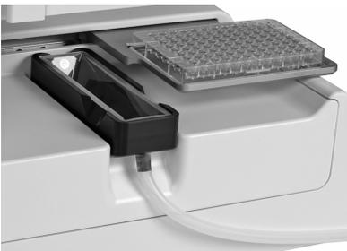
Verbinden Sie den Abflussschlauch mit dem Anschlussstutzen der Abflusswanne.
