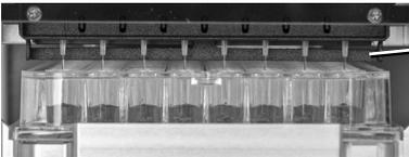
Der Anti-Kollisionsstreifen der Dispensierkassette schützt die Düsen vor Kollisionen
