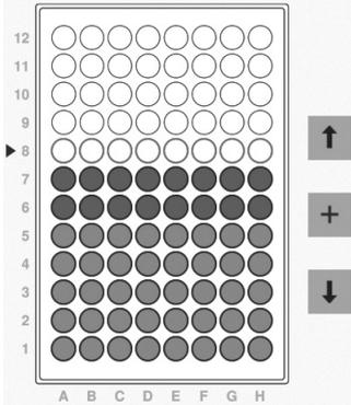
Bewegen Sie den Cursor mit dem Pfeil nach oben oder unten auf die gewünschte Spalte (A-H). Drücken Sie die Plustaste, um weitere Spalten darüber auszuwählen (farbiger Wellrand). Geben Sie das Dispensiervolumen ein und bestätigen Sie mit dem Pfeil nach oben oder unten (gefüllte Wells).
