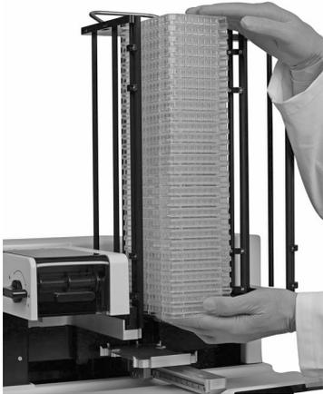
Öffnen Sie die Türen des Turms (15) und schieben Sie einen Stapel leerer Platten nach hinten in den linken Turm.
