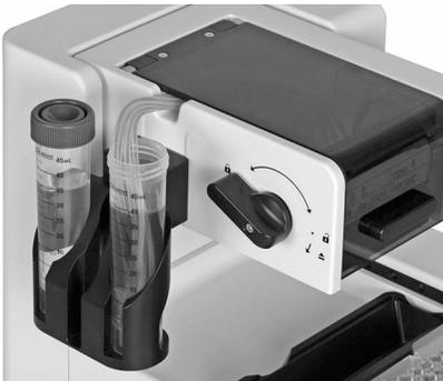
Schieben Sie den Röhrenhalter über die Befestigungsleiste (6).
