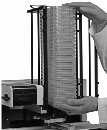
Ouvrez les portes de la colonne (15) et insérez une pile de plaques vides dans la colonne gauche.
